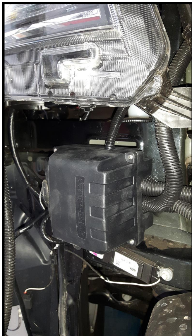
Montowanie przekaźnika. Mounting the relay.
