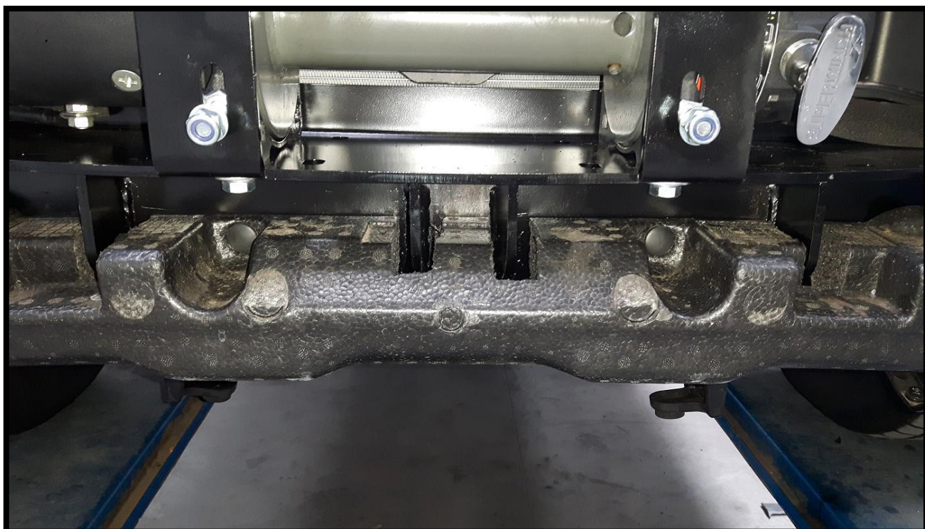
Montowanie rolki przedniej . Mounting of the front roller.
