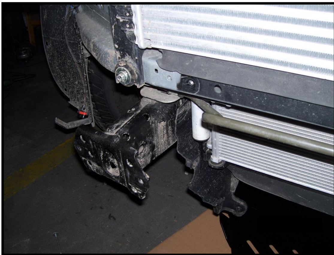
Montowanie płyty wciągarki Mounting of the winch plate
