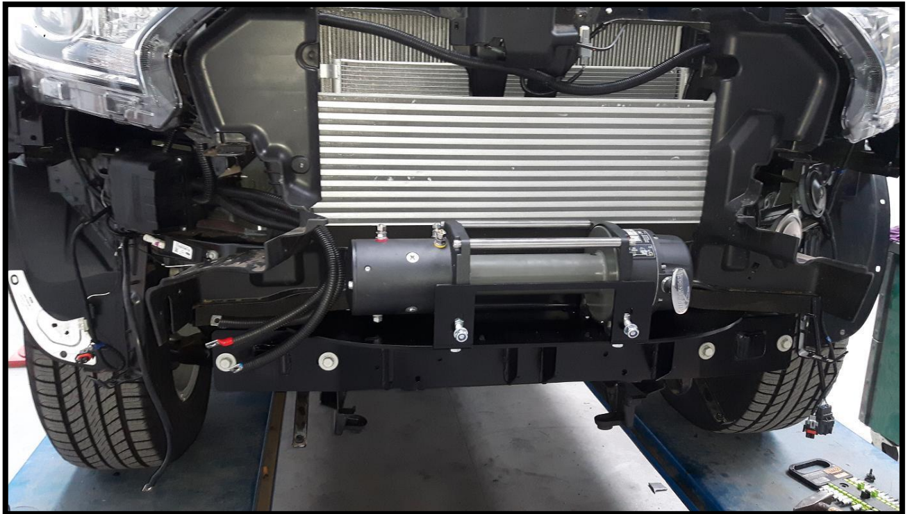
Montowanie wyciągarki Mounting the winch
