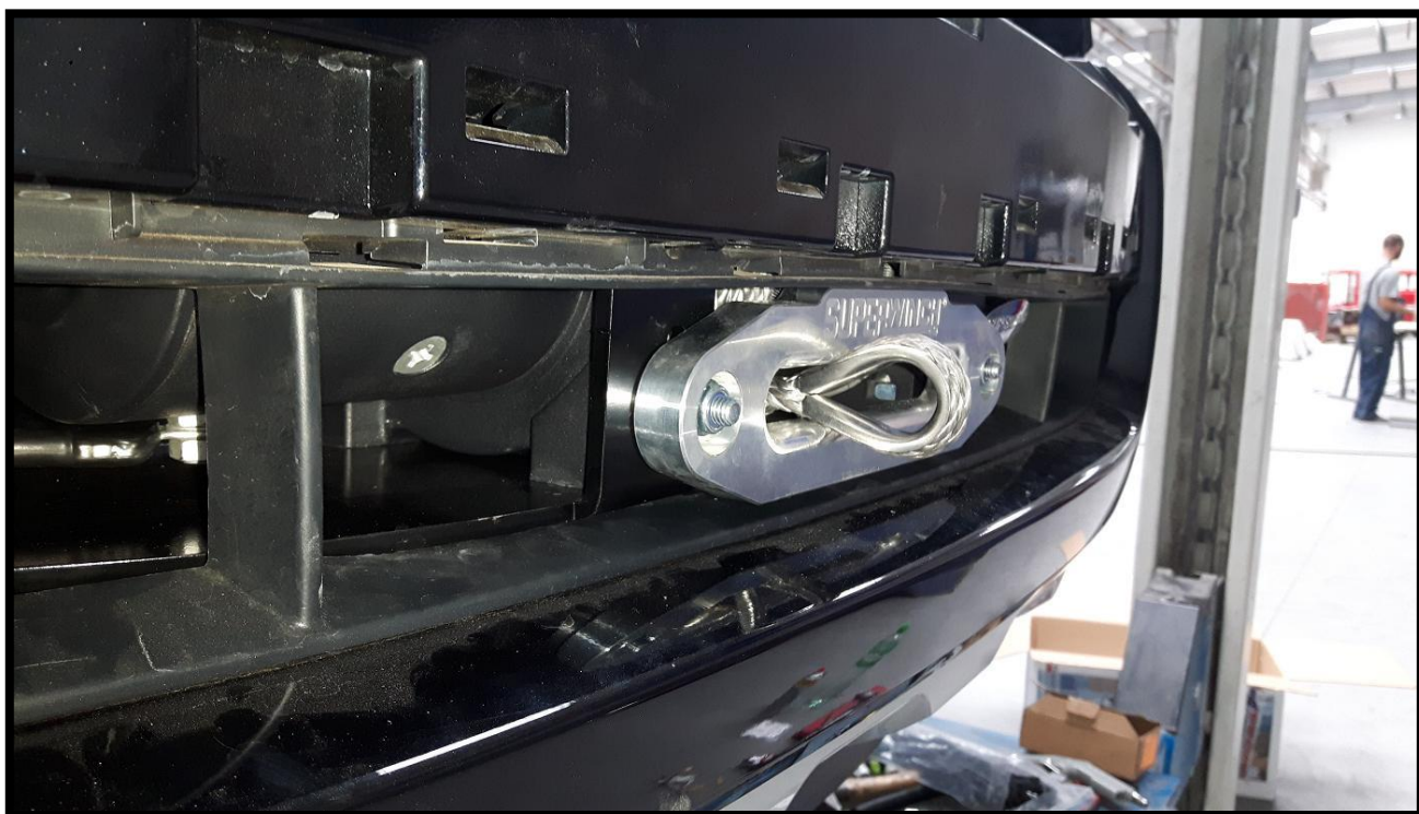
Montowanie rolki przedniej . Mounting of the front roller.
