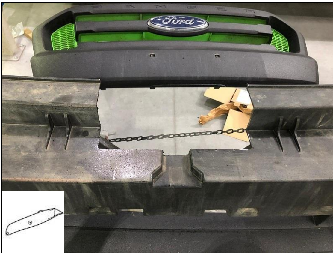
Dopasowanie i montowanie przedniej plastikowej osłony. Adjusting and mounting the front plastic cover.
