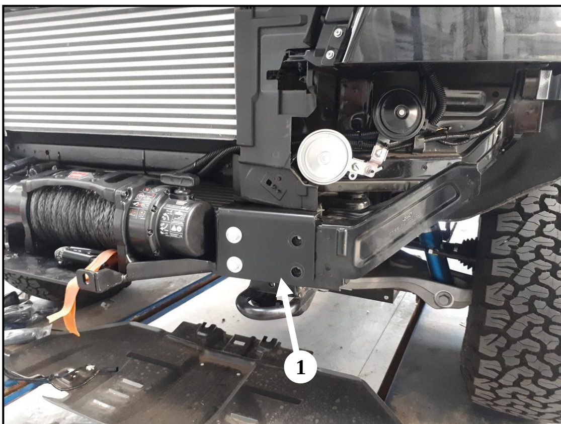
Montowanie wyciągarki. Mounting the winch.
