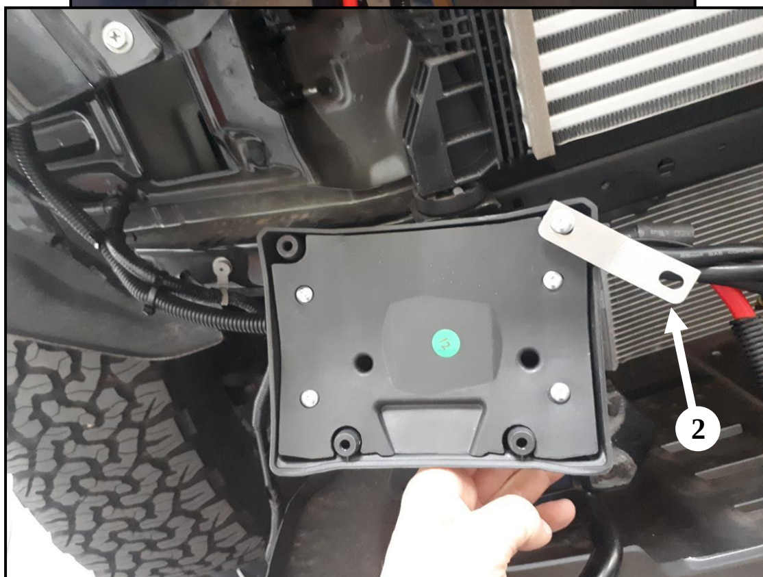
Mocowanie przekaźnika za pomocą mocowania nr.2 Fastening the relay with the mounting No. 2
