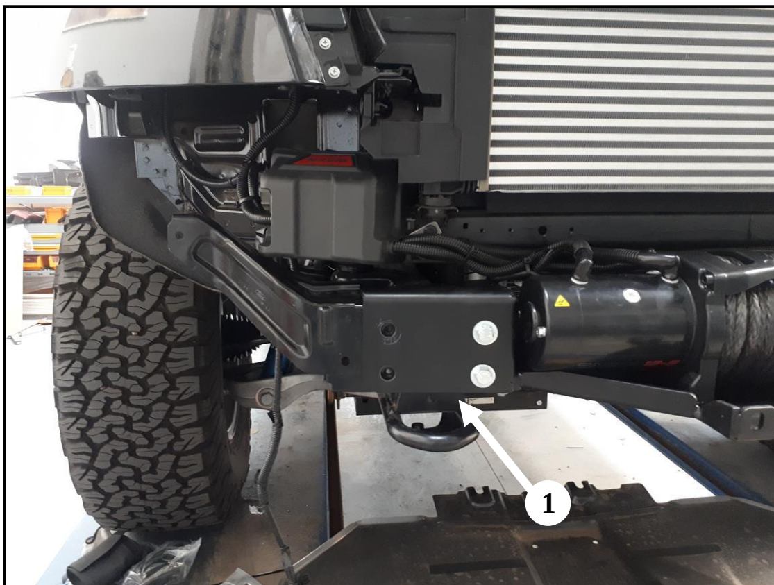
Montowanie wyciągarki. Mounting the winch.
