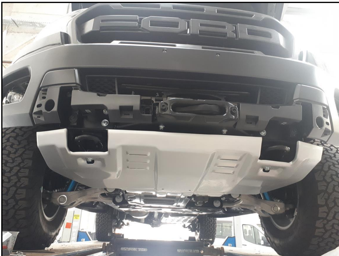
Mocowanie osłony dolnej. Attaching the bottom cover.
