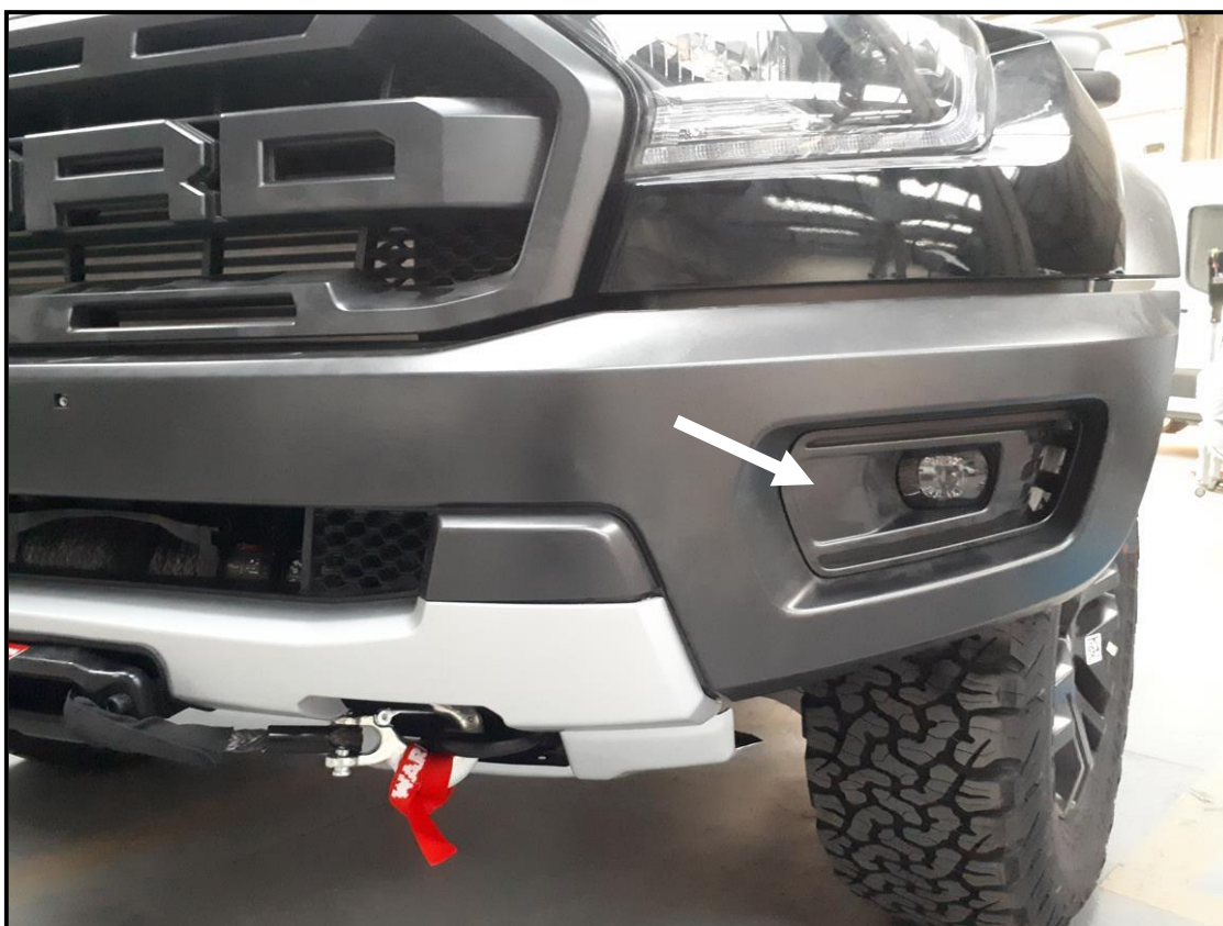
Nałożenie osłon bocznych na lampy. Putting side covers on the lamps.
