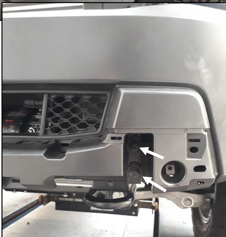
Montaż zderzaka przedniego względem śrub oryginalnych belki przedniej. Installation of the front bumper relative to the original bolts of the front beam.
