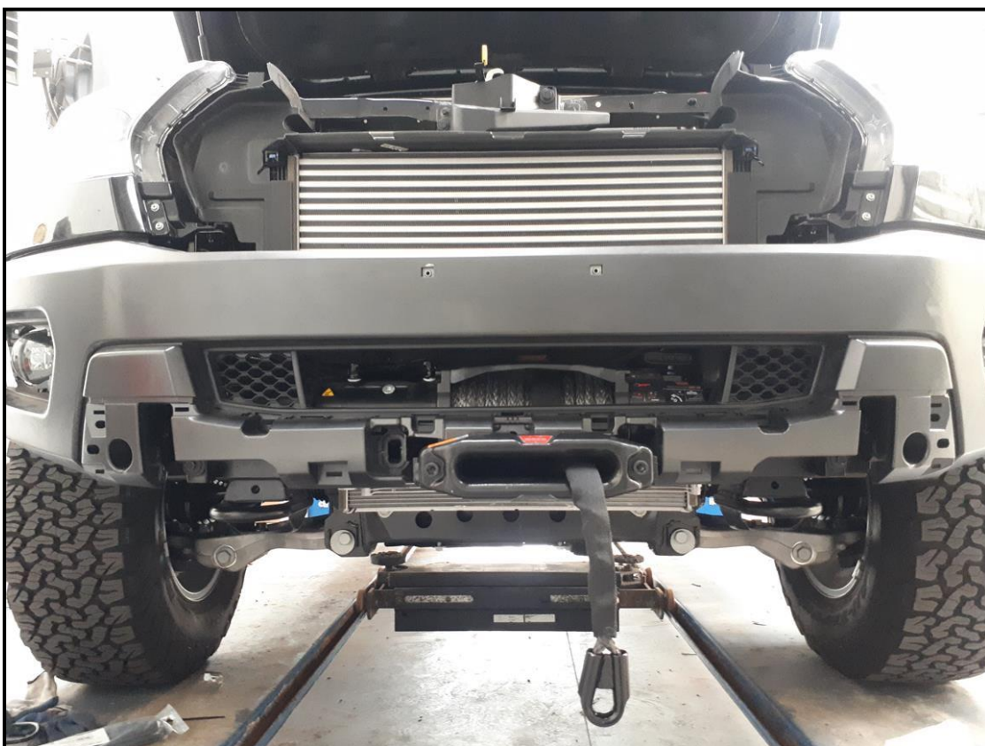
Założenie przedniego zderzaka na przód samochodu. Installing the front bumper on the front of the car.
