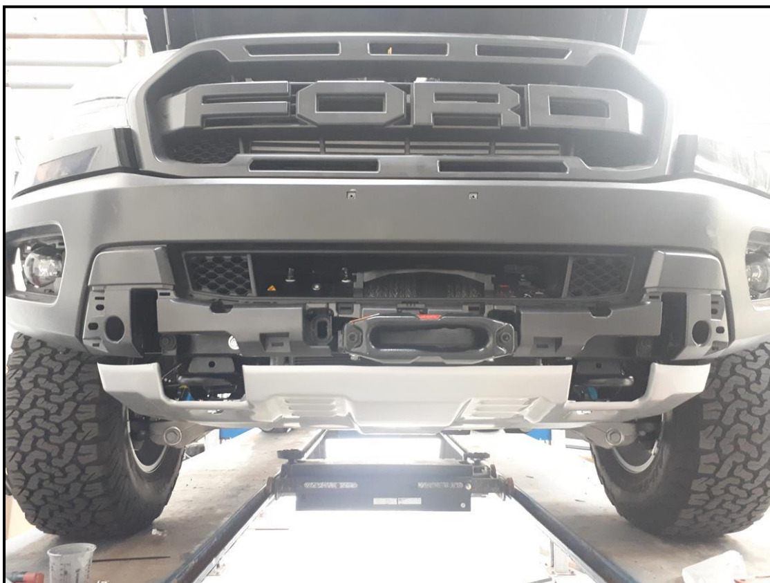
Mocowanie osłony dolnej. Attaching the bottom cover.
