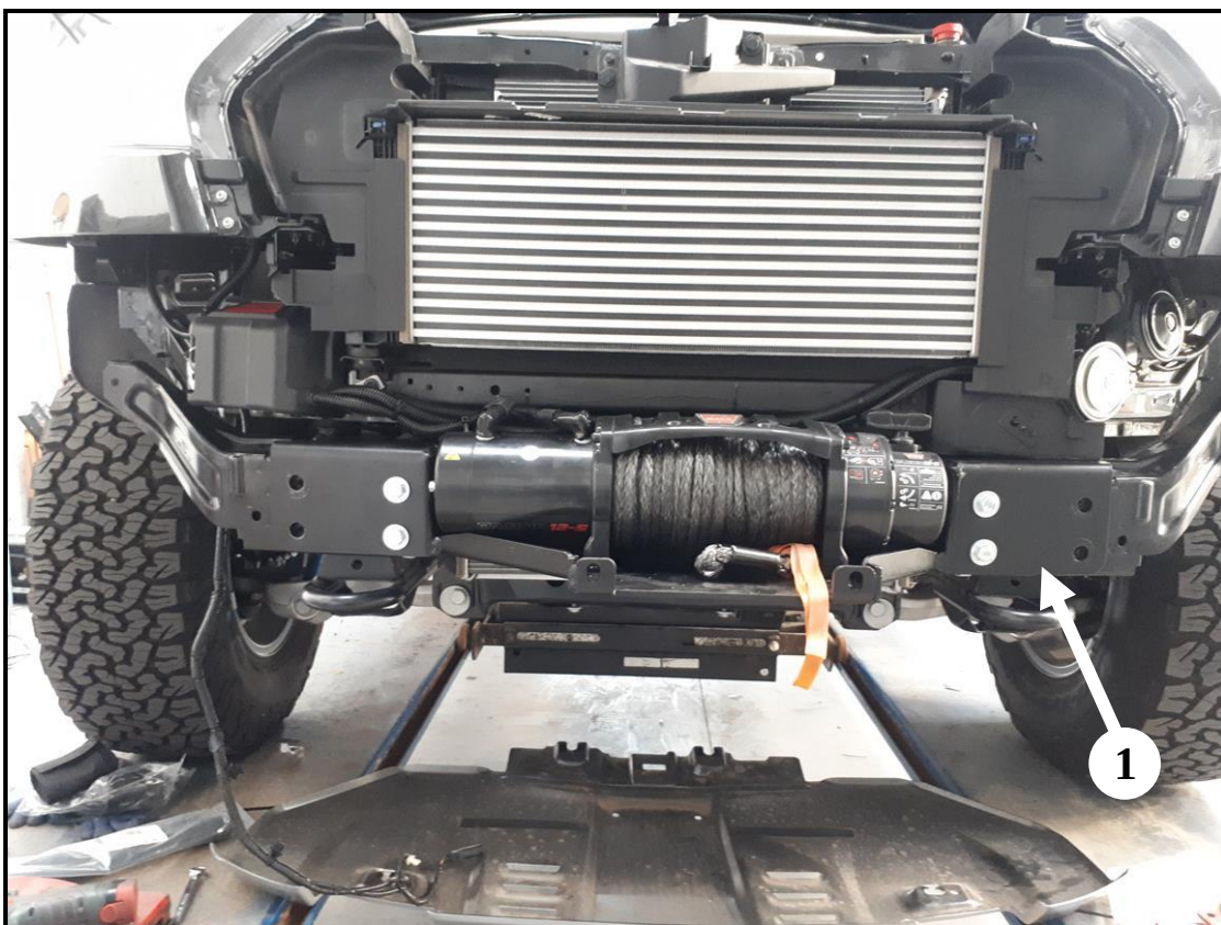
Założenie przedniego zderzaka na przód samochodu. Installing the front bumper on the front of the car.
