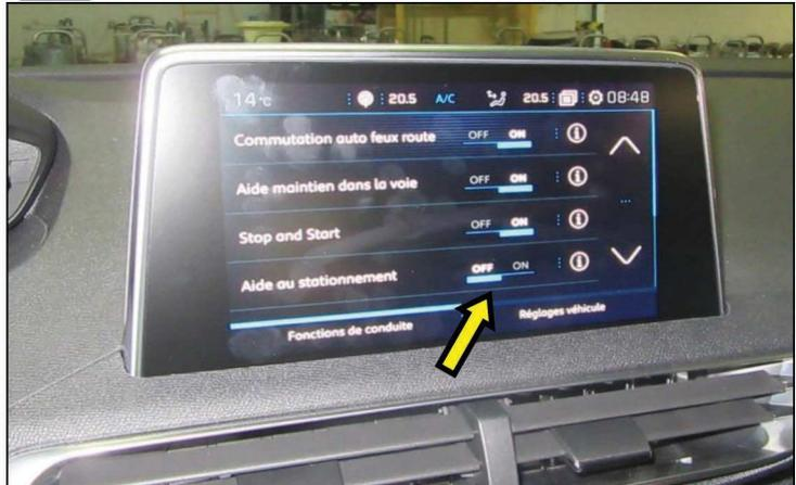
Lors du branchement de la remorque ,désactiver le système "RADAR DE RECUL" au tableau de bord
