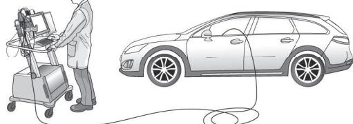
Die Beleuchtungsfunktionen am Anhänger funktionieren nur NACH Konfiguration des Fahrzeuges auf Anhängerbetrieb!
