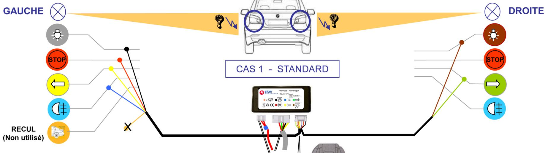
Tester les fonctions véhicule et connecter selon les couleurs indiquées (étiquette sur le module) sur les câbles des feux arrière. Pour les système multiplexés (2 fonctions dans le même fil), consulter la page 3.
